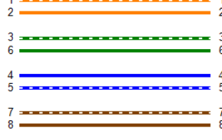
Схема разводки (T568B) PASS
