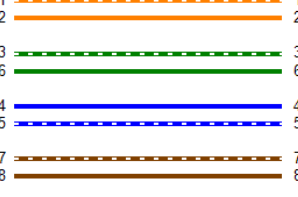
Схема разводки (T568B) PASS
